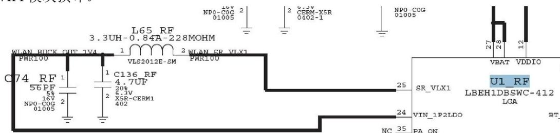
实物测试点在屏蔽罩内，测量时注意，点到 C136\_RF 即可测到电压：
