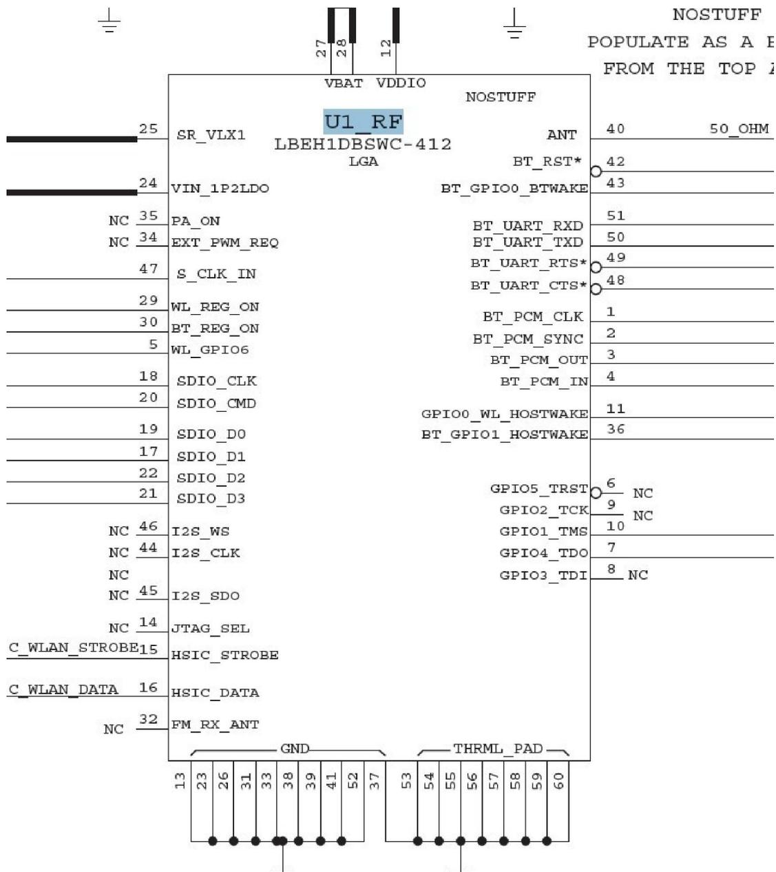
一个芯片要正常工作首先要具备三大基本条件，供电，复位，时钟，看上图，供电脚是 27 28 脚，我们通常把这个点叫做 B+，复位脚是 12 脚，时钟脚是 47 脚，要确定故障点首先需要测量这个三个点的电压和频率，实物测试图如下：
