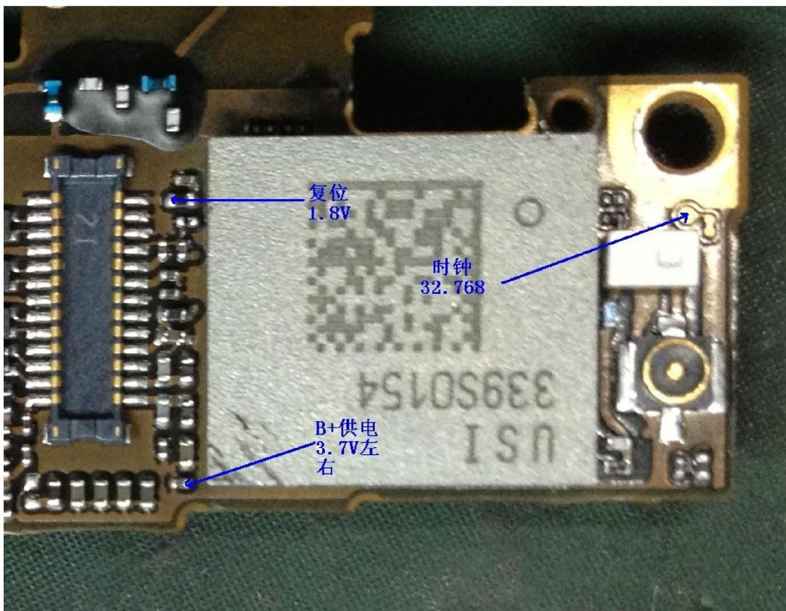
上述三大测试点如果有一个不正常都会导致无 WIFI 故障，通常 B+ 没有的问题比较多，这个可以直接飞线解决，如果三大点电压都正常，接下来就要确定是 WIFI 模块自身的问题，我们可以通过检查芯片的 LDO 电压来大致判断 WIFI 模块是不是损坏了，看图纸的 L65\_RF 电感，测量 C136\_RF 端电压是不是已经有了，正常一般 1.2V 左右，如没有或者太高，都是 WIFI 模块损坏。
