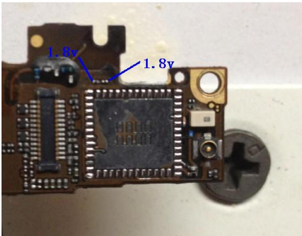
焊下芯片清洗好焊盘再上锡，更换上新的 WIFI 模块，特别要注意 WIFI 模块上端的两个 10K 小电阻不能搞掉或者脱焊，这是 WIFI 模块选通信号和数据信号的上拉 1.8V 电阻，这个有问题同样也会导致无 WIFI。
